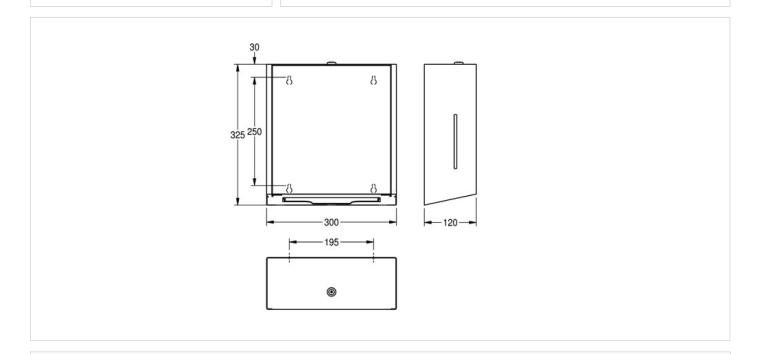
Distributeur de serviettes en papier EXOS à installation murale en acier inoxydable de 1,2 mm d'épaisseur (calibre 18), fini satiné, façade et boitier recouverts d'InoxPlus prévenant les traces de doigts et facilitant le nettoyage. Fenêtre d'inspection latérale, capacité de 300 à 400 serviettes en papier pliées en Z. Fixations incluses.
