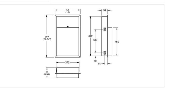
Bac à déchets Franke RODAN RODX605E, 690 x 408 x 169mm (27-1/8 x 16 x 6-5/8 po), installation encastrée, fait d'acier inoxydable de 0,8 mm d'épaisseur (calibre 22), grade 18-10, type 304, surface au fini satiné, capacité de 23 L (6,08 gal), dispositif de verrouillage avec clé Franke standard, accessoires d'installation inclus. Vérifiez les codes locaux concernant les exigences sur l'accès universel.
