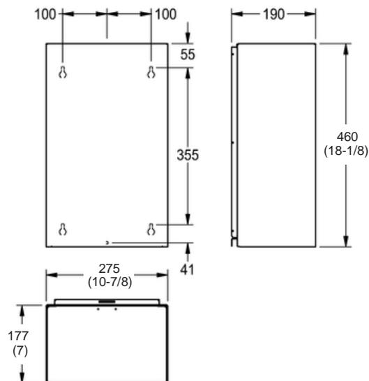
Bac à déchets Franke RODAN RODX605S, 460 x 275 x 177mm (18-1/8 x 10-7/8 x 7 po), installation murale, fait d'acier inoxydable de 0,8 mm d'épaisseur (calibre 22), grade 18-10, type 304, surface au fini satiné, capacité de 18 L (4,75 gal), accessoires d'installation inclus. Fournir une surface de fixation adéquate et vérifier les codes locaux concernant les exigences sur l'accès universel.
