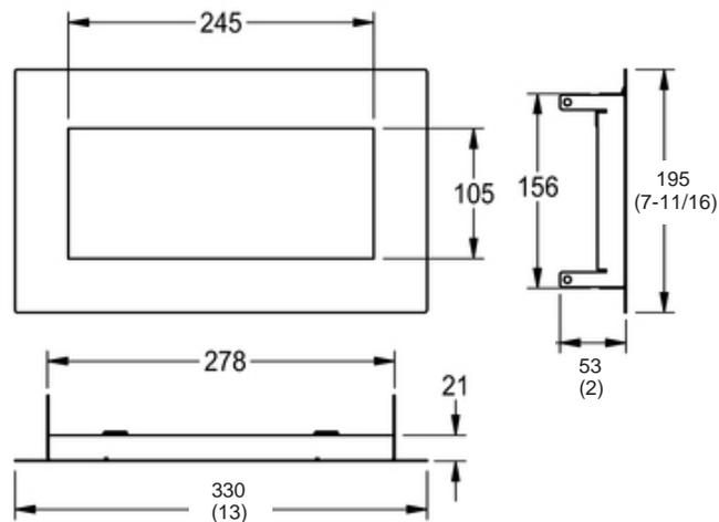
Panneau à battant Franke RODAN RODX605TT pour bac à déchets, 195 x 330 x 53mm (7-11/16 x 13 x 2 po), installation sur comptoir, fait d'acier inoxydable de 0,8 mm d'épaisseur (calibre 22), grade 18-10, type 304, surface au fini satiné, fermeture automatique, bac à déchets non inclus. Accessoires d'installation inclus. Vérifiez les codes locaux concernant les exigences sur l'accès universel.
