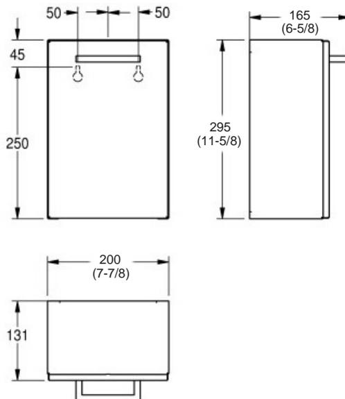
Bac à déchets pour produits d'hygiène féminine Franke RODAN RODX611, 295 x 200 x 165 mm (11-5/8 x 7-7/8 x 6-5/8 po), installation murale, fait d'acier inoxydable de 0,8 mm d'épaisseur (calibre 22), grade 18-10, type 304, surface au fini satiné, porte avant à ouverture complète, capacité de 3,7 L (1 gal), contenant en plastique amovible et accessoires d'installation inclus. Fournir une surface de fixation adéquate et vérifier les codes locaux concernant les exigences sur l'accès universel.
