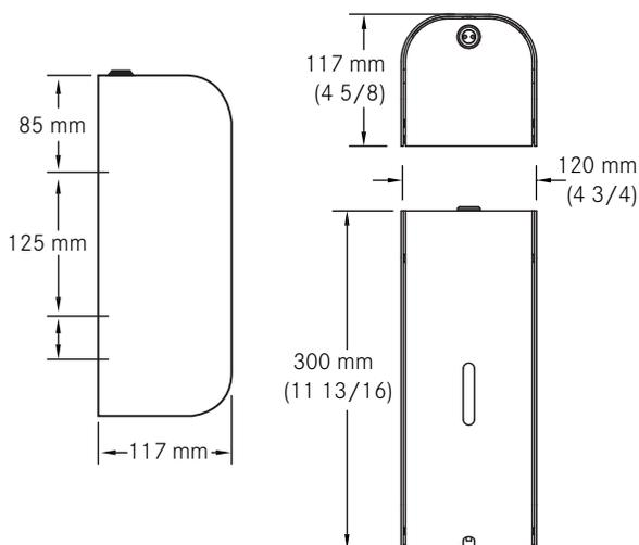
Remarque : La distance entre le dessous de l'unité et le dessus du plan de travail doit être au minimum de 300 mm (12 po).
